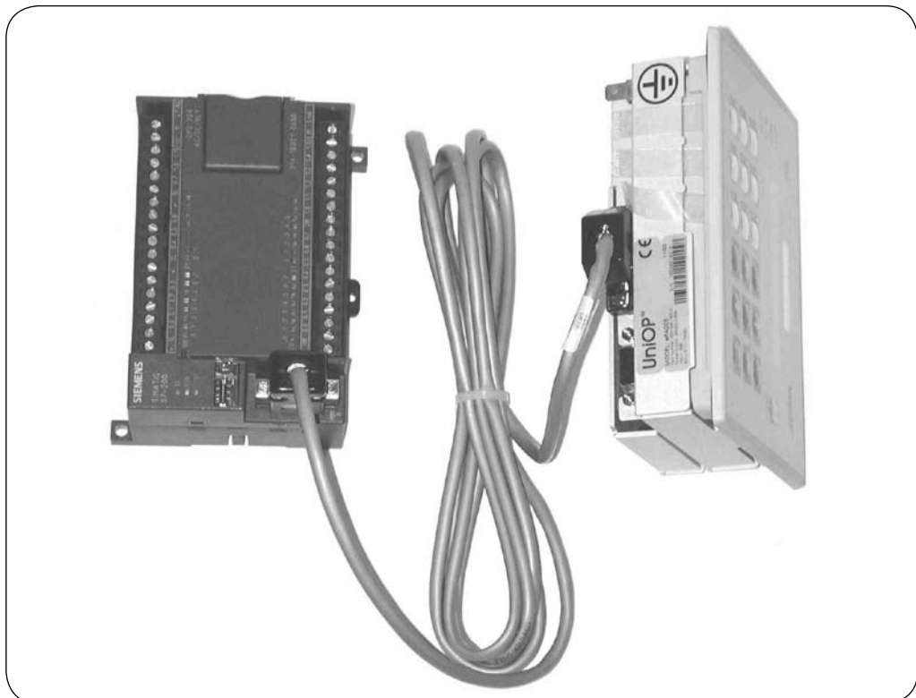
Fig. 19: connessione dell'UniOP™ con il PLC
